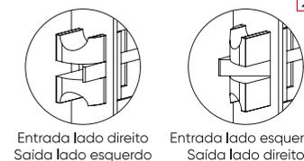
2.3.1. Mova o corpo do bloco até o outro lado. Empurre o trinco (1P) da fechadura interna (1D) para dentro, comprimindo a mola, e gire 180 graus. Depois solte-o e coloque o corpo do bloco de novo na posição que estava.
