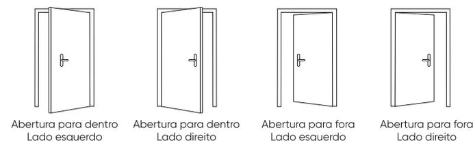
2.2. A seguir, verifique a direção da maçaneta de acordo com a direção de abertura da porta. Se a direção não for a mesma, altere a maçaneta conforme indicado:
